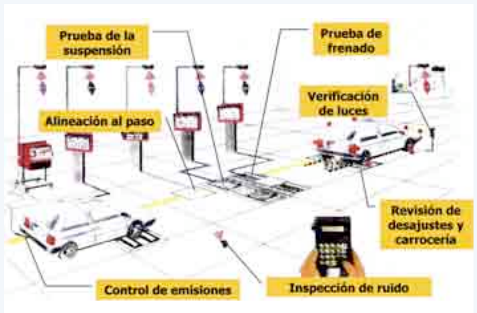
Figura 1: Diagrama esquemático de una línea de Inspección Técnica Vehicular Informatizada
