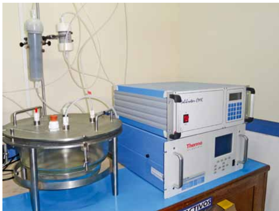
Sistema de generación de patrones de tubos pasivos, Laboratorio de Calidad del Aire, IIDEPROQ/UMSA
