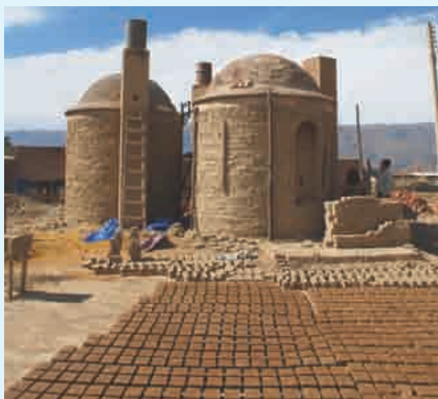
Horno Piloto tipo MK, nueva tecnología para la producción artesanal de ladrillos
