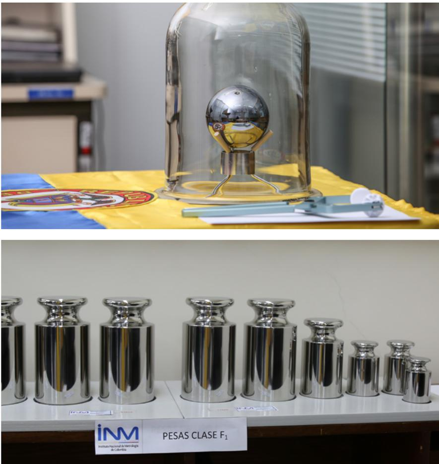
**Ilustración 1.** Esfera de Silicio. Pesas clase F1. Trazabilidad del Laboratorio de masa del INM
