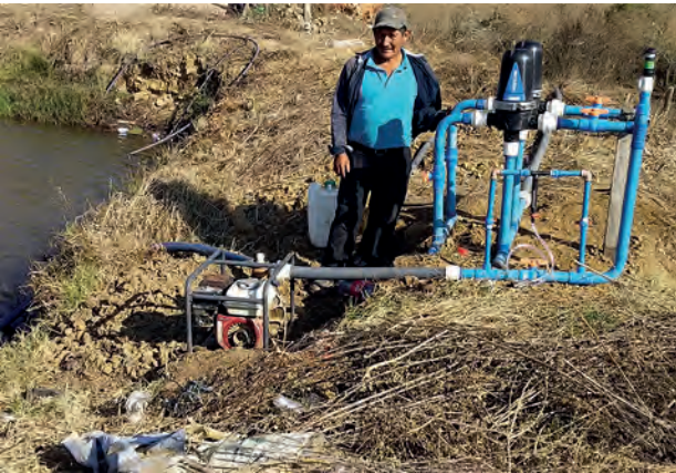
Foto 5.3. Cabezal de riego por goteo.
